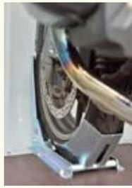
フロントタイヤのロック機構により、バイクを垂直状態で収納できる。これにより省スペース化を実現！
