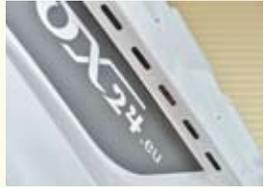
リアセクション上下部などに、雨水の浸入を防ぎながら内部換気ができる、ベンチレーションホールがある
