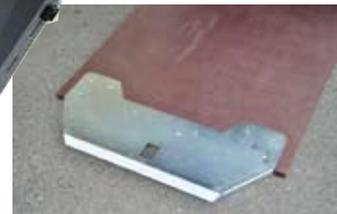
合板にフェノール樹脂コーティングを施した、耐溶液性や耐熱性に優れる床材を採用。エンド部を金属で補強する
