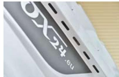
リアセクションの横側上下部には、雨水の浸入を抑制しながら内部の換気ができる、小さなベンチレーションホールが数多く設けられている
