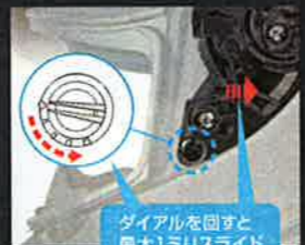
ダイヤルを回すことで、シールドベースが5段階にスライド。シールド密着性を左右とも最大1ミリの幅で微調整が可能。
