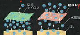
従来ナイロンの約2倍の吸放湿性でさらさらとした肌ざわりを実現するとともに、ナイロンポリマー中に、熱伝導性の高い特殊無機粒子をブレンドすることで、接触冷感も併せ持つ。
