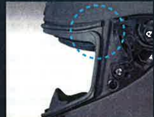
上方と側面のリップ形状を独立させることで、柔軟性を高めシールドとの密着性が向上したウィンドアップディング。密着を高めることにより走行時の空気の漏れによる風切音発生を防ぐ。
